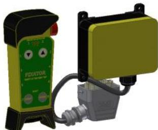
Consta de un emisor (IP65) y de un receptor con antena interna (IP66 – radio de acción de 75 a 100 m).
