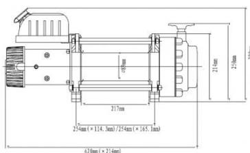
Treuil de véhicules électriques 24 V pour camions, gros 4x4, utilitaires. Force 7938 kg. Modèle avec câble acier.
