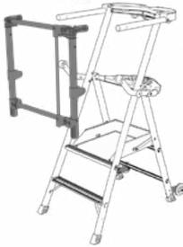
2. Retirer le pantographe
