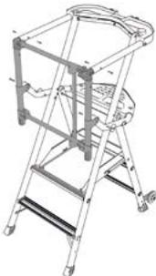
2. Fixer le pantographe à l'aide de la nouvelle visserie fournie
